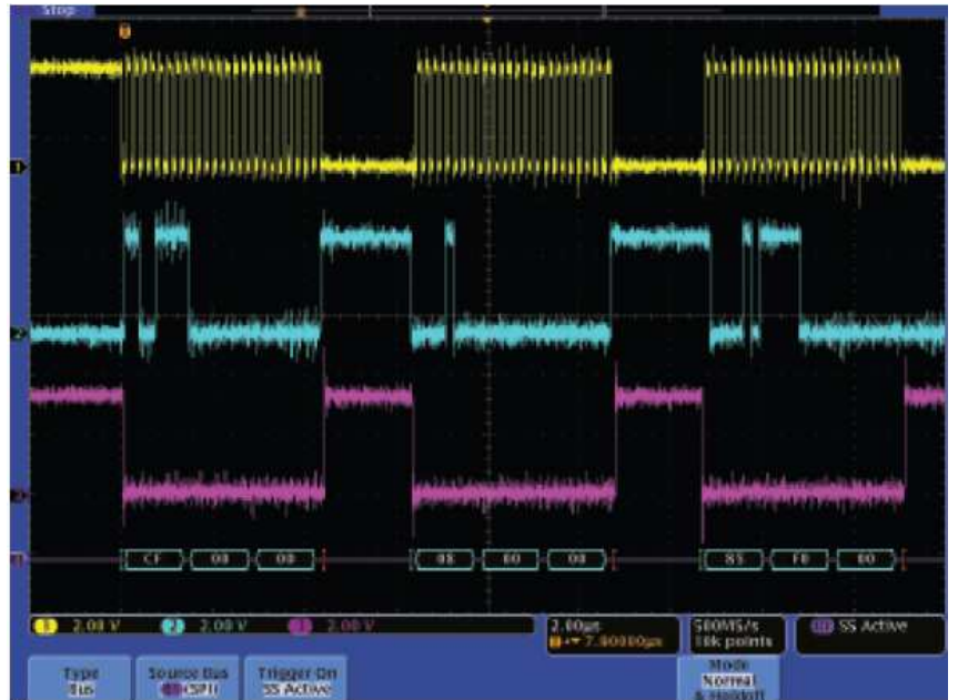
그림 12 SPI 버스의 신디사이저 구성 메시지 획득
