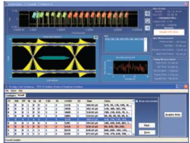
그림 27. FlexRay 신호에 대한 아이 다이어그램 분석
