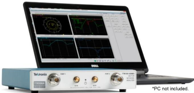
TTR500의 각 포트에 대해 독립적인 RF 소스와 3개의 RF 수신기를 사용하면 1 포트 또는 2 포트 테스트 대상 장치 (DUT)로 고정밀 크기 및 위상 측정을 수행할 수 있습니다. TTR500을 사용하여 DUT의 완전한 S11, S12, S21 및 S22 측정을 수행하고 다양한 형식으로 데이터를 표시하십시오 (측정 기능 표 참조).
